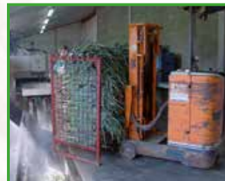
Het in de hoogte plaatsen van de bak met preien met de heftruck.
