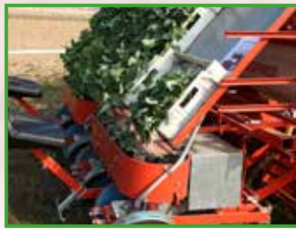
© Pluk-o-trak Munchkof De machines om fruit te oogsten verkleinen de reikafstanden en de afstanden om het fruit te plukken.
