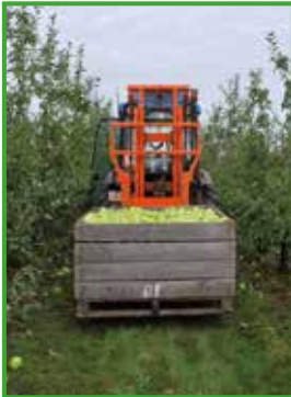
Door het mechaniseren van de verplaatsing van pallets worden krachtinspanningen die gepaard gaan met een manuele verplaatsing vermeden.
