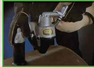
Schuurmachine (zandstraalmachine met lucht) die minder trillingen produceert en het afval veroorzaakt door polijsten opzuigt. (Educomatic van Airblast - http://www.airblast.co.uk/cgi-bin/ab_page.pl?ref=3.3.4 )
