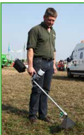
Verstuiver met verlengstuk voorkomt het zich voorover buigen
