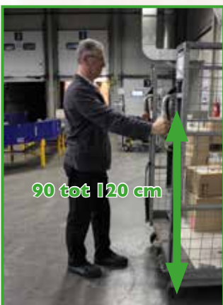
Karretje met handgrepen op gepaste hoogte (tussen 90 en 120 cm)
