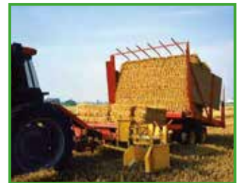
(© HSE) Een balenstapelaar of -verzamelaar vervangt manuele behandeling.
