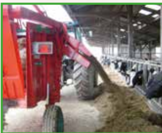
(© HSE) Met een doseermachine kan het voedsel worden verdeeld in de bakken zonder krachtinspanningen.
