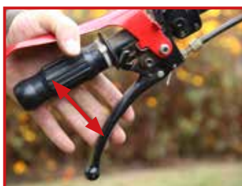
Snoeischaar met instelbare afstand, in functie van de afmetingen van de hand (S tot XL)
