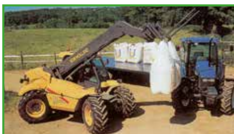
De verzameling van zakken in één grote van het type big bag, mechanisch verplaatst via een takel of met de vorken van de tractor, vervangt de vele verplaatsingen met zakken.
