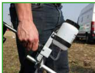
Verstuiver met verlengstuk voorkomt het zich voorover buigen
