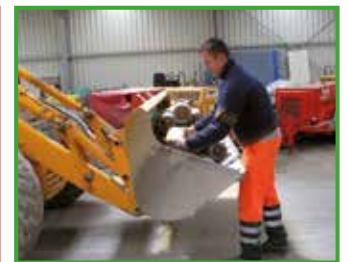
Hoger plaatsen van de grijper om de opgeslagen objecten te kunnen opnemen zonder zich te moeten bukken.
