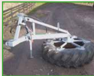
(© HSE) Een "lanceermechanisme voor kuilvoer", gemonteerd op een tractor, maakt het gemakkelijk om het voedsel zo dicht mogelijk bij de voedingszone te laten neerkomen.
