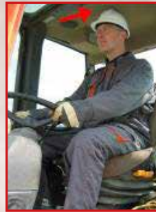
Onvoldoende afstand tussen het hoofd van de persoon en het plafond van de cabine
