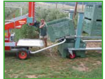
© Pluk-o-trak Munchkof De machines om fruit te oogsten verkleinen de reikafstanden en de afstanden om het fruit te plukken.
