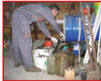
Onvoldoende plaats om het olievat te bereiken
