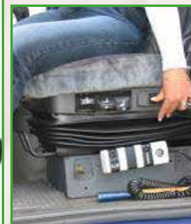
Stoel met een pneumatische vering
