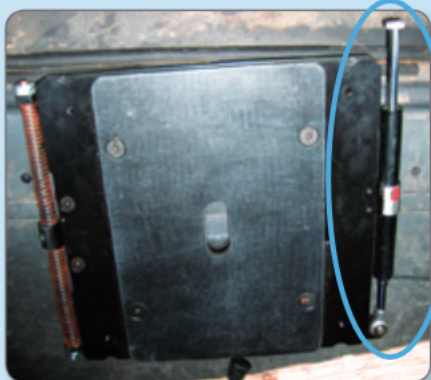
Horizontale vering aan de tractorzetel die aan- of uitgeschakeld kan worden.
